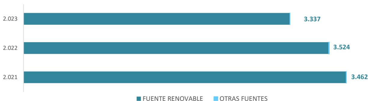
En 2023, El 99,9 % de la energía consumida en el CAM proviene de fuentes renovables, por la generación de la electricidad mediante el aprovechamiento del biogás del vertedero siendo mínima la adquisición energética proveniente de otras fuentes no renovables. Además, mediante la venta de electricidad procedente de fuente renovable el CAM contribuye significativamente a la sostenibilidad energética de la ciudad.
